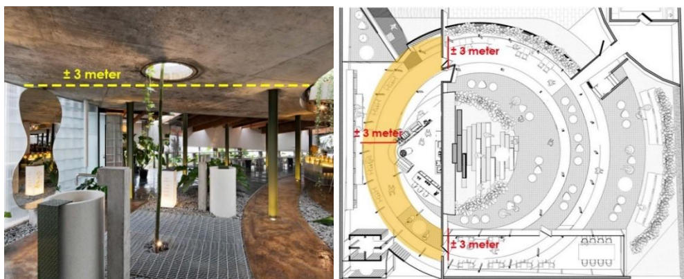
Gambar 5. Dak beton dengan bentang terlebar 3 meter
