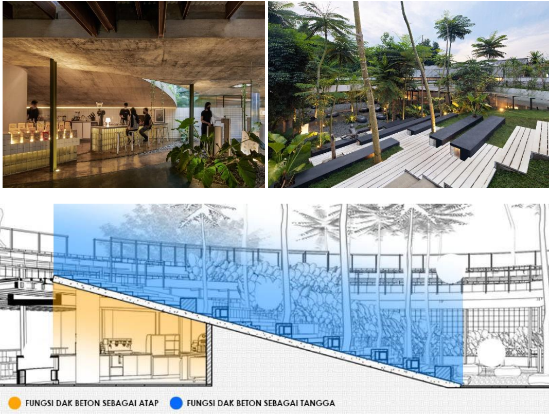
Gambar 6. Potongan plat beton sebagai atap sekaligus tangga pada bangunan Sumber: Abdel, 2021 dengan olahan penulis
