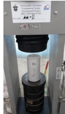
Gambar 7. Pengujian kuat tekan menggunakan alat Universal Testing Machine (UTM)
