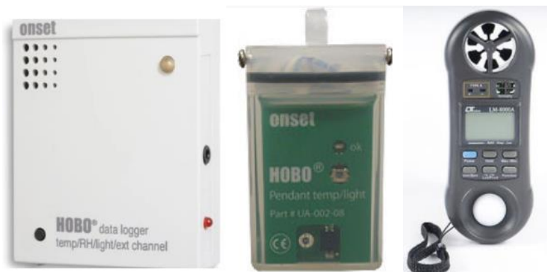
Gambar 1. Ilustrasi Alat Ukur Hobo U12-012 (Kiri), Hobo U002-64 (Tengah), dan Lutron LM-8000A (Kanan)
