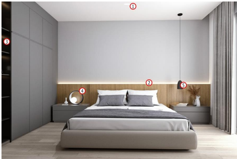
Gambar 1. Sistem Pencahayaan Berdasarkan Fungsi pada Kamar Tamu MT House. (1) General Lighting , (2) Accent Lighting , (3) Task Lighting (Sumber : Dokumentasi Pribadi)
