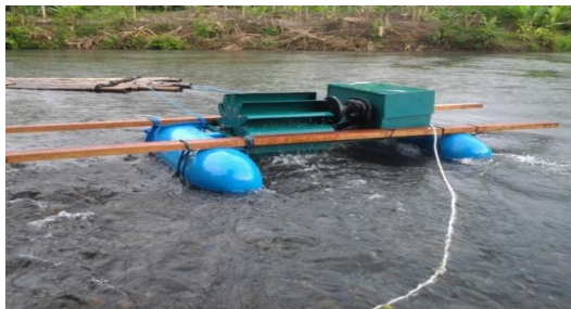
Gambar 4. Uji Coba Pembangkit Listrik Tenaga Mikro Hidro Terapung (PLTMHT)
