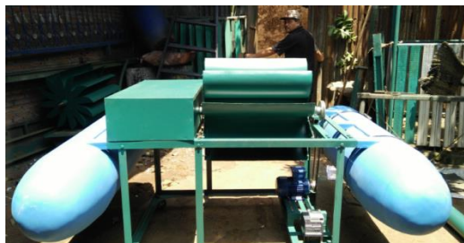
Gambar 3. Teknologi Tepat Guna: Pembangkit Listrik Tenaga Mikro Hidro Terapung (PLTMHT)
