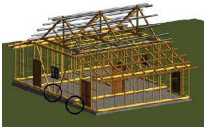
Gambar 5. Sistem struktur dan kontruksi Folajiku Sorabi Sumber: Olahan penulis, 2024
